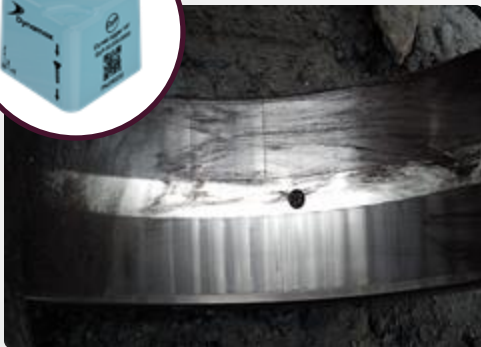
Defeito de pista externa em rolamento de mancal de desvio de CTC
